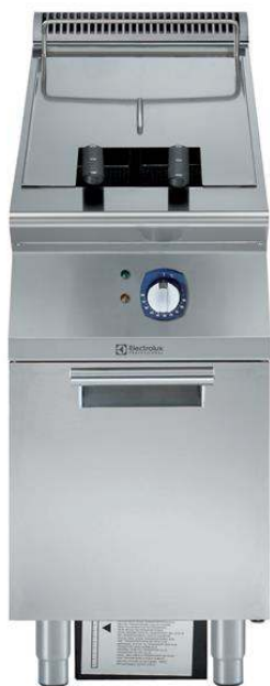
391337 (E9KKGDBAMCA) Fritéza, elektrická, 1x23L, "V" tvar vany s tělesy mimo vanu, 2x koš, 1/2 modul 400mm. Teplotní rozsah 105°-185°C, podstavba uzavřená pravými dvířky
